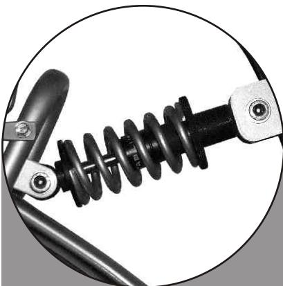
**Herzstück der SCHAUFF-Bandscheibenräder ist ein hydraulischer Stoßdämpfer im Hinterbau, der – gepaart mit einer in drei Härtegraden erhältlichen Feder – Fahrbahnunebenheiten "schluckt".**
