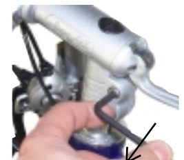
4. Vorbau im Uhrzeigersinn festschrauben
